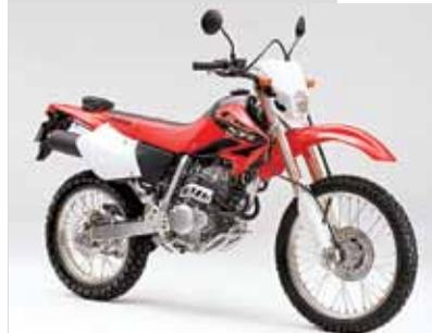
aluminio y un motor monocilíndrico SOHC de cuatro válvulas radiales RFVC (Radial Four-Valve Combustion Chamber) que entregaba 28 CV a 8.000 rpm de potencia máxima y 2,6 kgm a 7.000 vueltas en cuanto a torque máximo. Como dato relacionado al confort, el sistema de arranque era eléctrico. La imagen que acompaña el recuadro corresponde a una de las versiones cromáticas de 2005, la cual se mantuvo inalterable hasta el cese de producción de dicha doble propósito.
