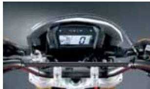
**Desde el tablero de datos se puede saber lo que pasa con la velocidad de marcha, la cantidad de kilómetros recorridos totales y parciales, la hora y las funciones de la secuencia de testigos (luz alta, giros, punto muerto, chequeo de motor y temperatura del líquido refrigerante).**
