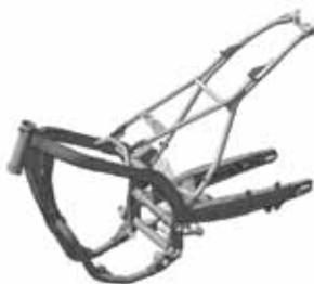
**Dibujo de computadora del bastidor y del basculante.**
