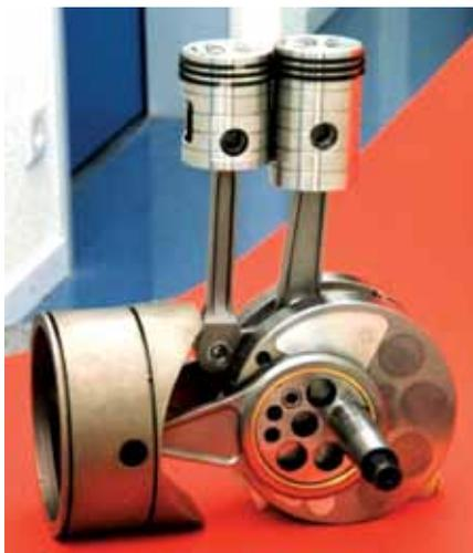
**Fig.1 Motor de competición de DKW con compresor**
