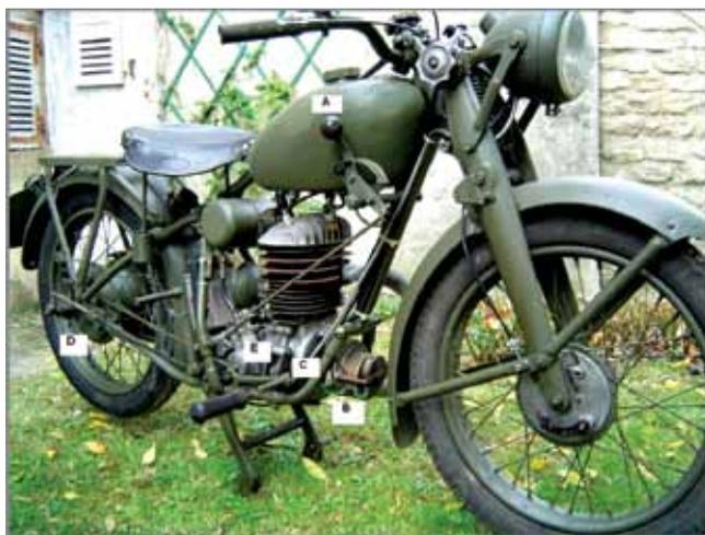
**Fig. 7. Puch 250 cc modelo 1940. Notesé A; la palanca de cambios adosada lateralmente al tanque con una larga varilla de transmisión a la caja. B; ubicación del magneto o dinamo en el extremo frontal del cigüeñal. C; la carcasa del cárter que claramente indica que el volante está perpendicular a la dirección de marcha. D; el largo mando hacia el eje trasero para maniobra el embrague y E; la caja de velocidades que está situada en forma transversal a la dirección de marcha.**
