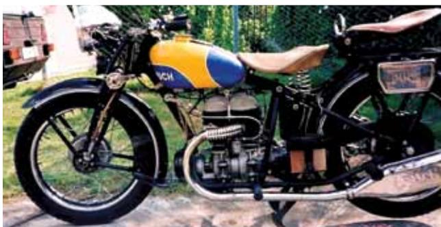
mas pesado para desacoplar todo. La caja de velocidades se operaba con una pequeña palanca que se situaba sobre el lado derecho del tanque, como era la usanza de la época. (Fig. 7) Si bien las primeras versiones fueron en 122 cc luego
