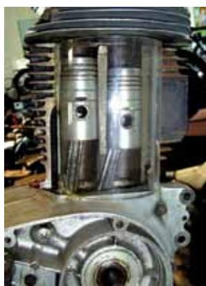
**Fig. 10 Motor Puch de cilindros plegados en tandem de postguerra.**
