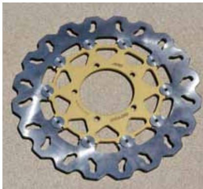
*Una Yamaha FZ 16 con 1.000 km. de uso en Buenos Aires, en su primer service. Se notan "rayitas" concéntricas en el disco. La arenilla y demás elementos abrasivos que flotan en el aire, producen su efecto en la superficie del disco.*
