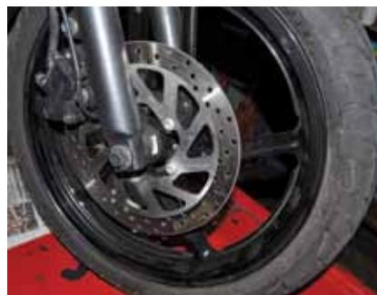
*Un disco de freno flotante sin uso, reemplazo "especial" para la Yamaha FZ 16.*
