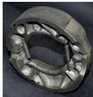
*Los patines con sus correspondientes resortes, listos para ser colocados en la placa portapatines trasera de una Yamaha YBR 125.*
