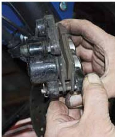
La pinza de freno, con las pastillas colocadas.
