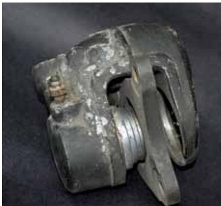
Una pinza de freno en estado lamentable. Se puede observar a la izquierda el "purgador" totalmente oxidado. La pieza cilíndrica de aluminio, es la que empuja a la pastilla de freno. En este caso está sin las pastillas y los pernos guía.
