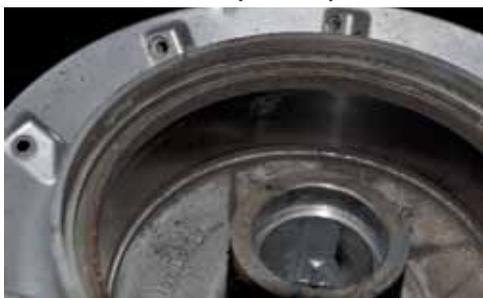
Una maza trasera de una Tornado. La parte brillante es donde apoyan los patines de freno. Si bien el escalón con la parte oxidada no llega al milímetro de diferencia, el no controlar la tensión de la cadena de transmisión produjo la rotura de la maza del lado del piñón.
